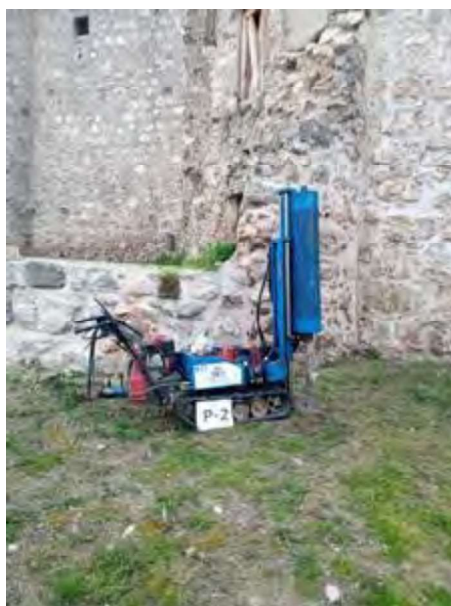
Ensayo de penetración dinámica P2
