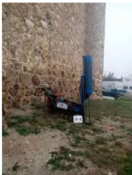
Ensayo de penetración dinámica P4
